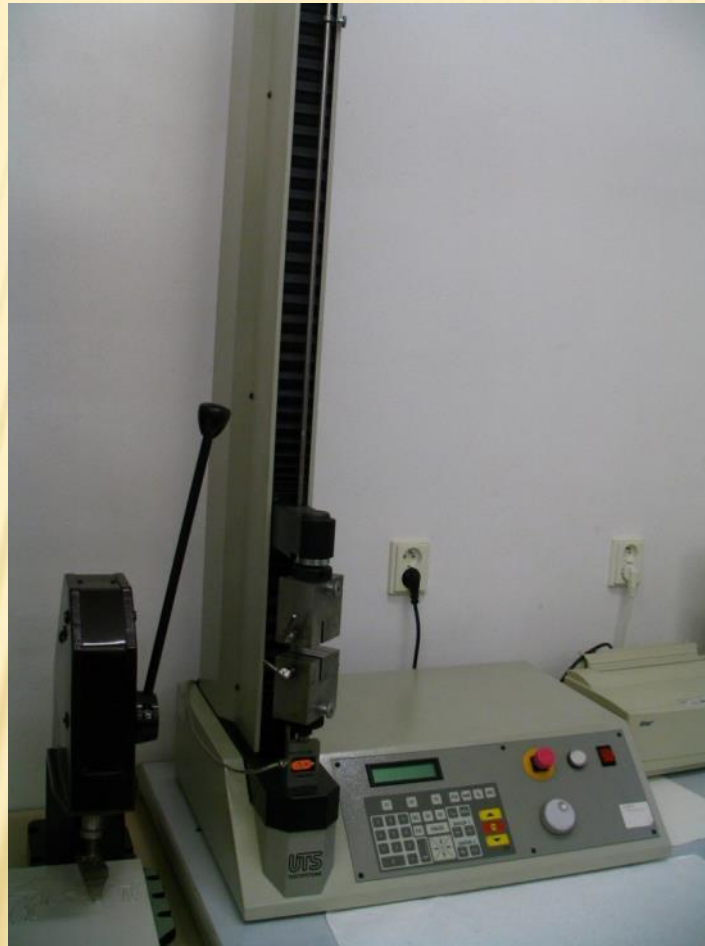
Univerzální zkušební stroj – měření pevnosti v tahu a tažnosti
